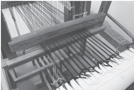
(図13) タテ糸の調整 布巻棒に取り付けた〈織出し布〉に糸を結ぶ。
