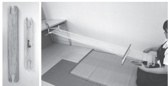
(図7) 製織作業 板杼（左）にヨコ糸（紡いだ糸）を巻きつけてタテ糸に挿入してゆく（右）。
