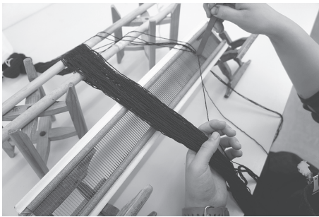
(図11) 箄通し 櫛状に隙間が空いており、その隙間に糸を通す。
