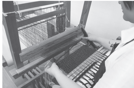
(図14) 製織作業 〈板籽〉に裂いた布を巻きつけ織ってゆく。
