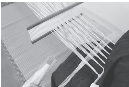
(図6) 幅出し 布巻棒に結んだタテ糸に太い紐を織り入れ、糸幅を整える。太い糸で織ることで隙間をなくす。
